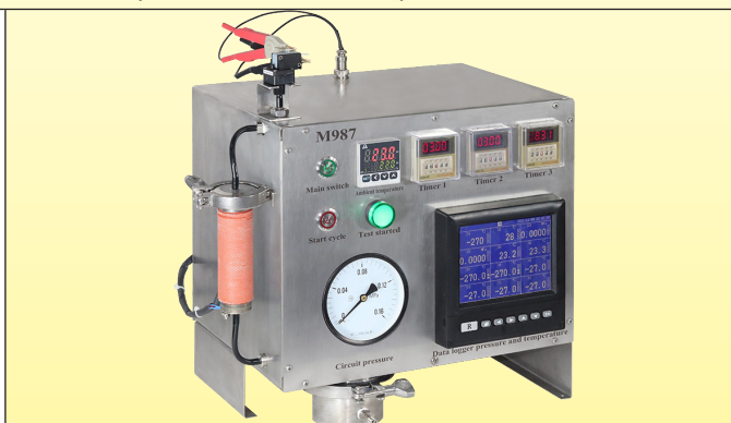
Equipo de ensayo para medir, registrar y ajustar los sistemas de compensación barométrica y de temperatura ambiente de los interruptores de aire (Laboratorio Ultimheat)
