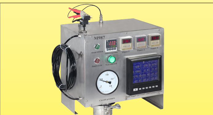
Equipo de ensayo para medir repetida y constantemente la longitud máxima de los tubos de conexión del pulsador de aire en función del volumen del pulsador y de la presión que desarrolla (Laboratorio Ultimheat)
